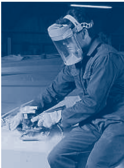
Aangedreven helm met gefilterde lucht voorzien van een veiligheidshelm
