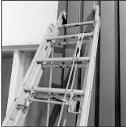
Ook de laddertouwen moeten regelmatig worden gecontroleerd.
