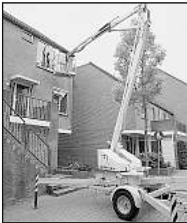
De knikarmhoogwerker kan in alle richtingen bewegen.
